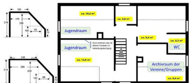
Abb. 46 Idee zur Neuordnung des Obergeschoss-Grundriss
